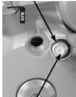
TAMPA DO ORIFÍCIO DE SINCRONIZAÇÃO
